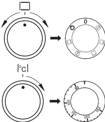
Beim Ausschalten des Geräts sind beide Schalter auf die „●“ / „0“ Position zu drehen..
